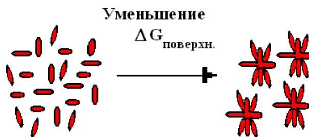
Рис. 22. Термодинамическая нестабильность наночастиц
